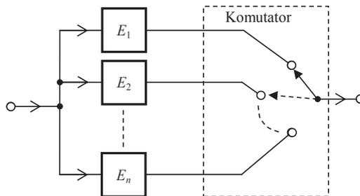
Slika 5.18. Idealni  $n$ -komponentni sustav s rezervom
