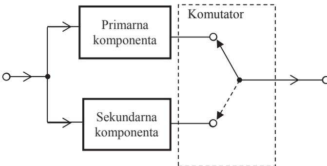
Slika 5.15. Simbolički prikaz idealnog dvokomponentnog sustava s rezervom
