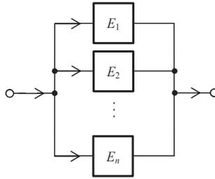
Slika 5.4. RBD  $n$ -komponentnog sustava paralelne strukture
