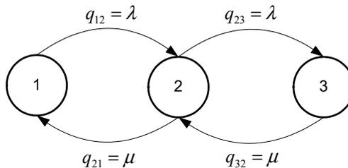
Slika 7.5. Dijagram stanja za određivanje raspoloživosti idealnog dvokomponentnog sustava s rezervom
