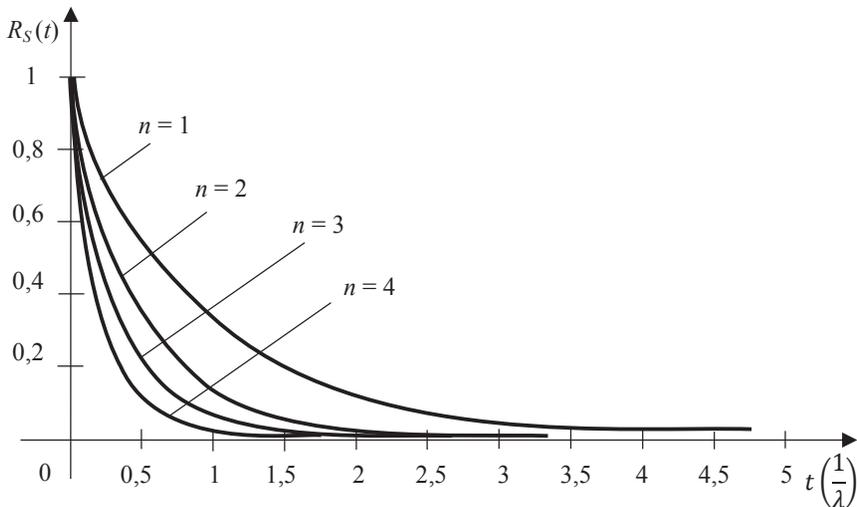
Slika 5.2. Dijagrami pouzdanosti sustava serijske strukture s komponentama konstantne i jednake učestalosti kvara
