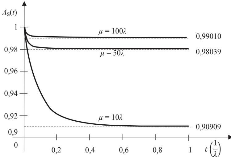
Slika 7.2. Vremenski dijagram trenutačne raspoloživosti jednokomponentnog sustava
