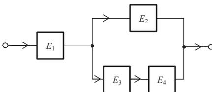
Slika 5.7. Primjer RBD četverokomponentnog sustava serijsko/paralelne strukture
