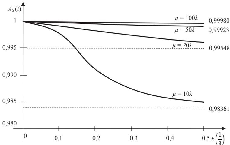
Slika 7.4. Vremenski dijagrami raspoloživosti dvokomponentnog sustava paralelne strukture
