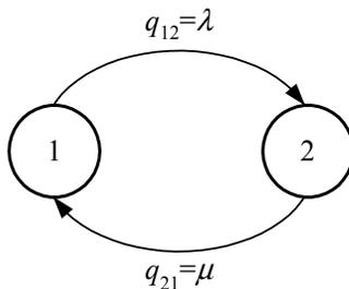
Slika 7.1. Dijagram stanja za određivanje raspoloživosti jednokomponentnog sustava
