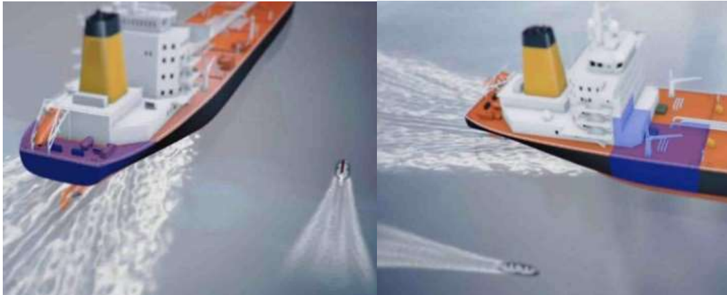
Slika 7. Krma i bočne strane oko nadgrađa - najosjetljivije točke napada pirata na brod
