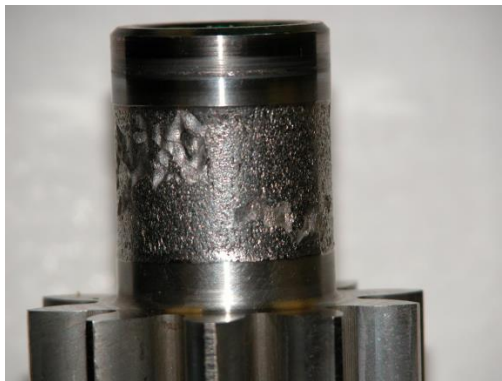
Slika 5.10 - Potpuno oštećenje ležaja
