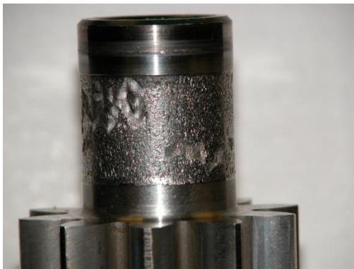
Slika 5.10 - Potpuno oštećenje ležaja
