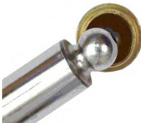
Slika 5.3. - Odvajanje sedla klipa
