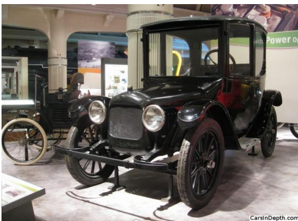
Slika 2.2. Woodsov hibridni automobil iz 1915. godine
