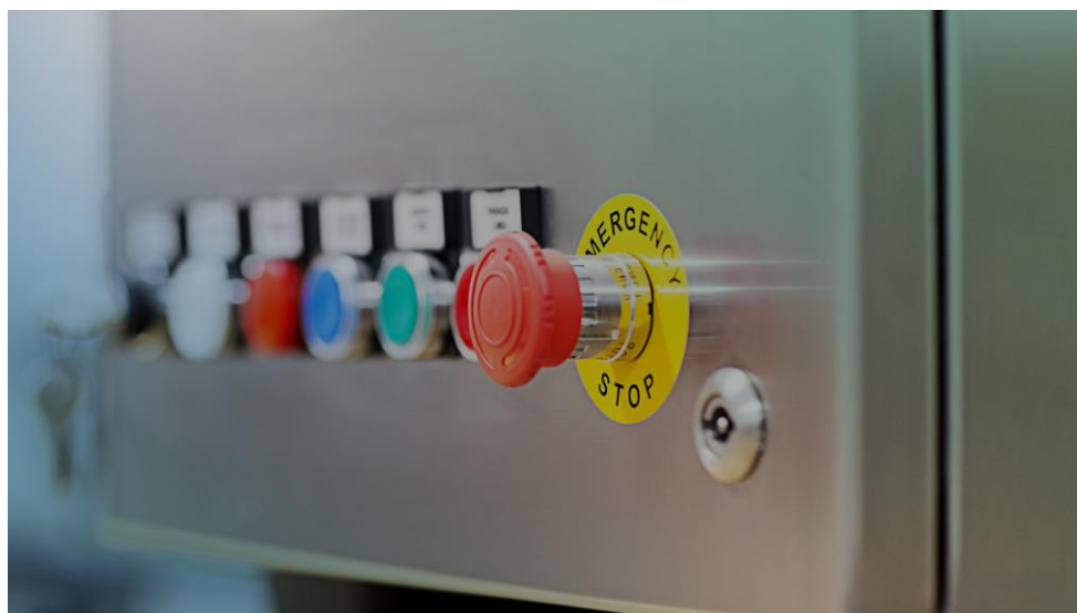
Slika 2: Prikaz ESD ručnog gumba
