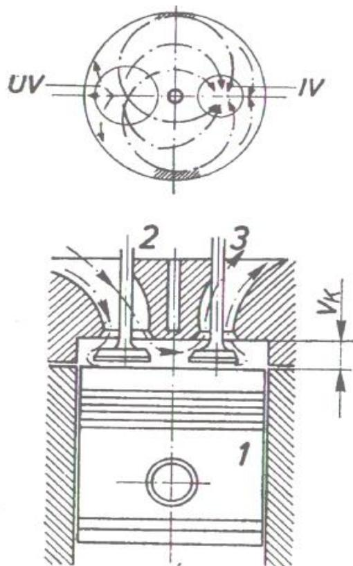
*Slika 6. Prikaz ispiranja u četverotaktnom dizel motoru [5]*
