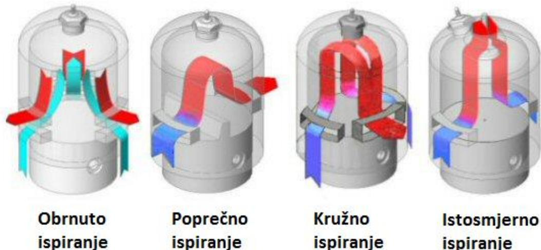
Slika 7. Prikaz sustava ispiranja kod dvotaktnih dizel motora [6]
