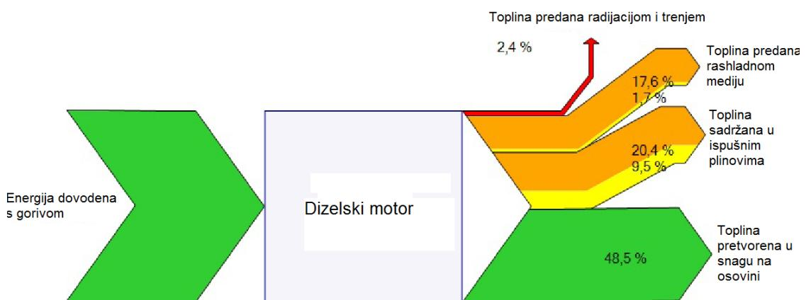
Na motoru MAN B&W 5L90MC praćenom na simulatoru prilikom povećanja temperature VT kruga sa 80°C na 90°C pri punom opterećenju specifična potrošnja goriva se smanjila za oko 0,7 g/kWh.
