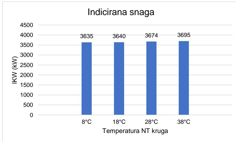
Slika 15. Dijagram indicirane snage na pojedinom cilindru
