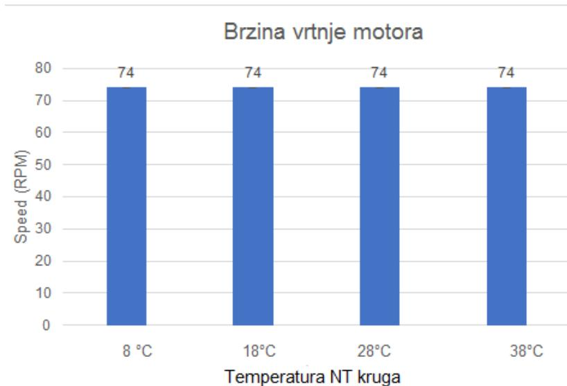
Slika 12. Dijagram brzine vrtnje motora na četiri temperature NT kruga
