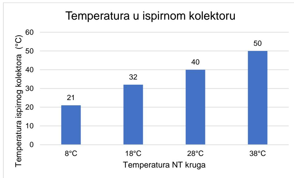
Slika 19. . Dijagram temperatura u ispirnom kolektoru
