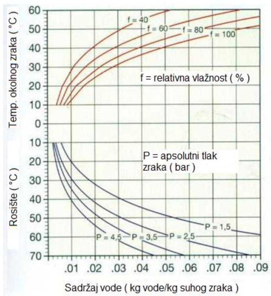
Slika 9. . Utjecaji relativne vlažnosti zraka, tlaka u ispirnom kolektoru i temperature rosišta na kondenzaciju vlage [7]
