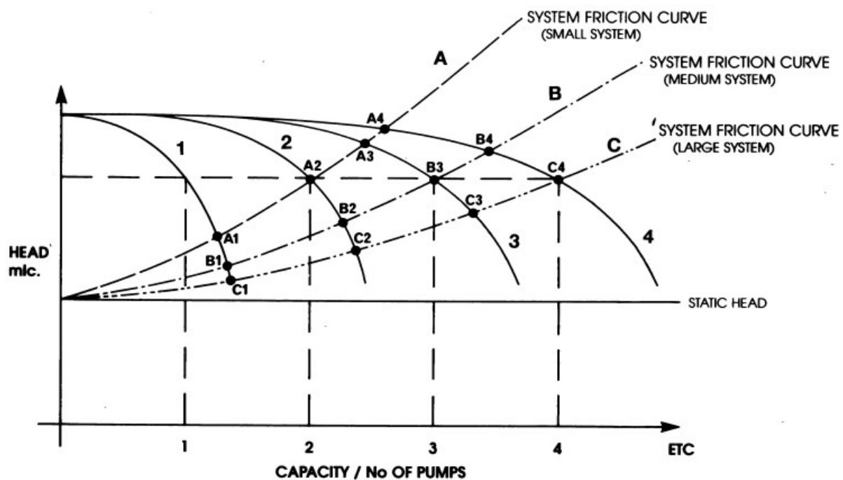
Slika 27. Karakteristike iskrcaja kod različitih otpora cjevovoda
