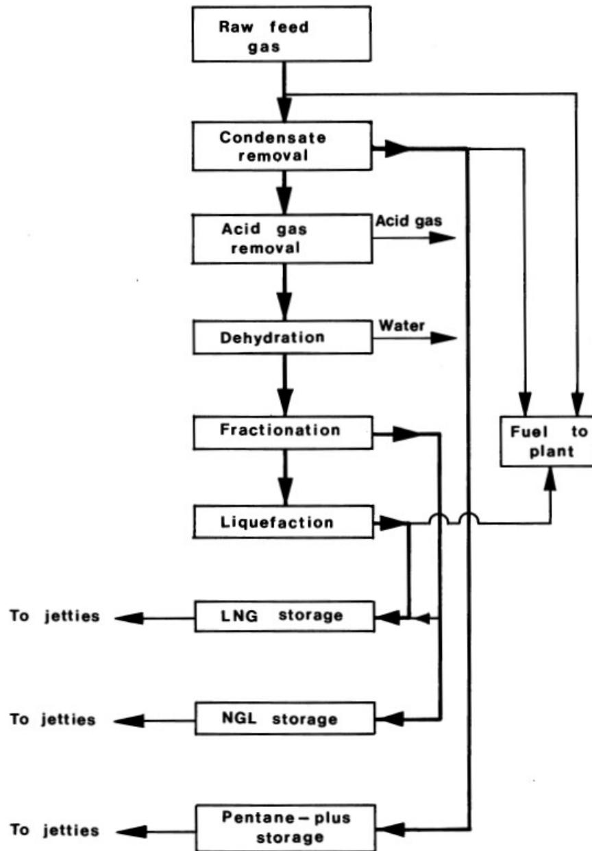
Slika 7. Obrada plina nakon crpljenja
