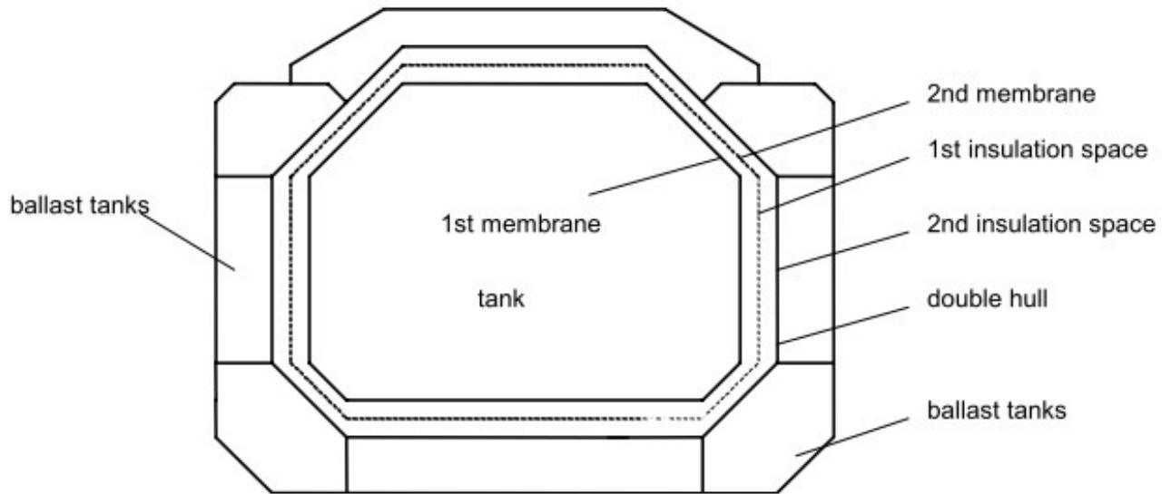
Slika 17. Presjek spremnika Technigaz
