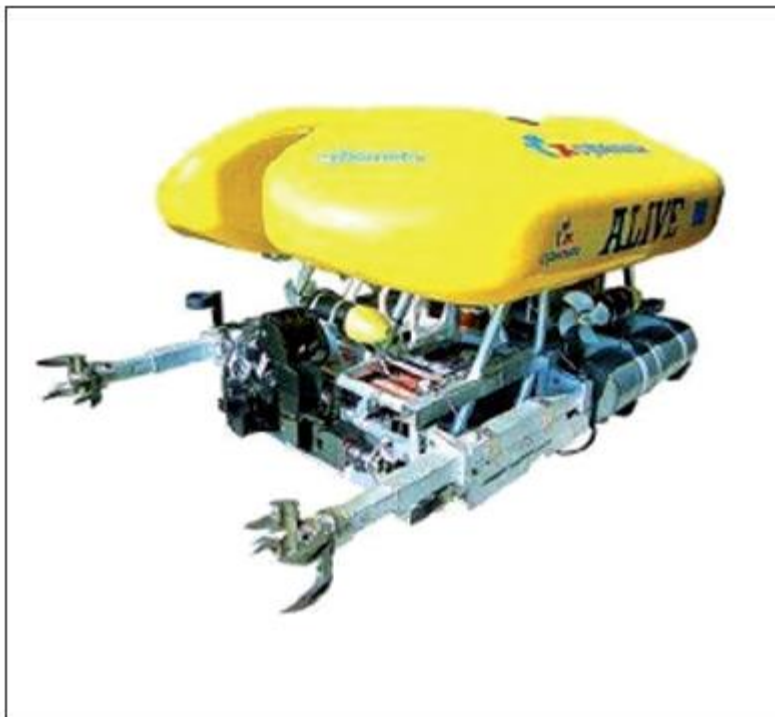
Slika 7. Lebdeća AUV ronilica (Izvor: www.perronerobotics.se/Images/Alive1.jpg )
