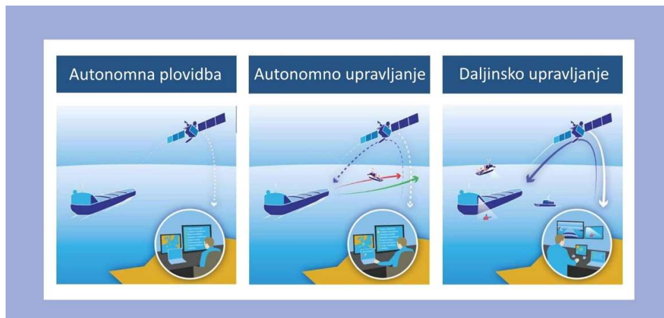
Slika 13. Prikaz 3 faze upravljanja brodom sa sustavom MUNIN [11].
