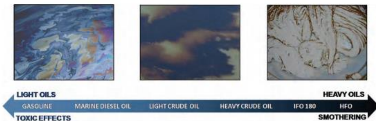
Slika 4. Utjecaj različitih vrsta goriva u intervalu od toksičnosti do zagušivanja
