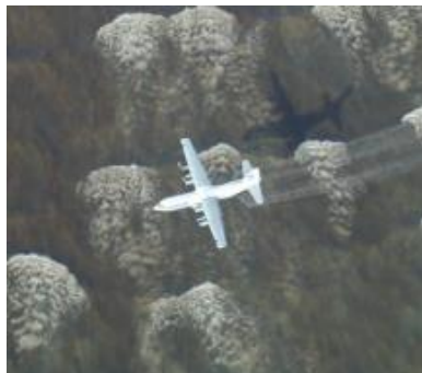
Slika 16. Nanošenje disperzanta putem aviona
