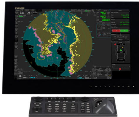
Slika 7. Radarski zaslon na zapovjedničkom mostu
