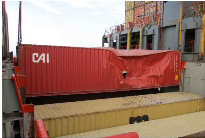
Slika 7: Prvi stupanj oštećenja kontejnera
