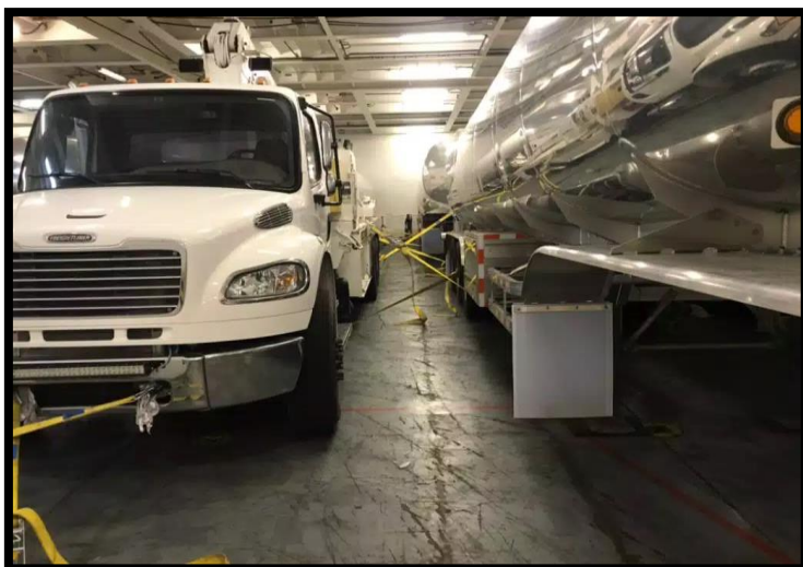
Slika 9 Učvršćivanje kamiona, kamionske prikolice
