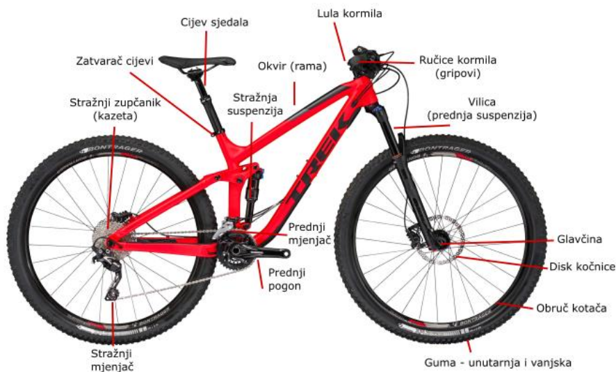
Slika 3 Bicikl sa označenim dijelovima Izvor : Rog joma (15.2.2020.)
