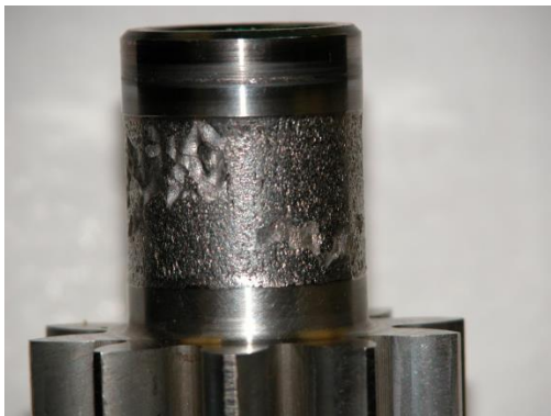
Slika 5.10 - Potpuno oštećenje ležaja
