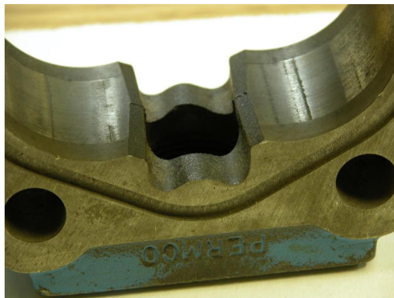
Slika 5.12. - Primjer postojanja manje kontaminacije u pumpi
