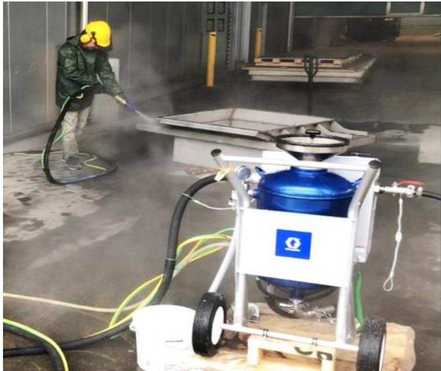
Slika 3. Prikaz pjeskarenja sa strojem
