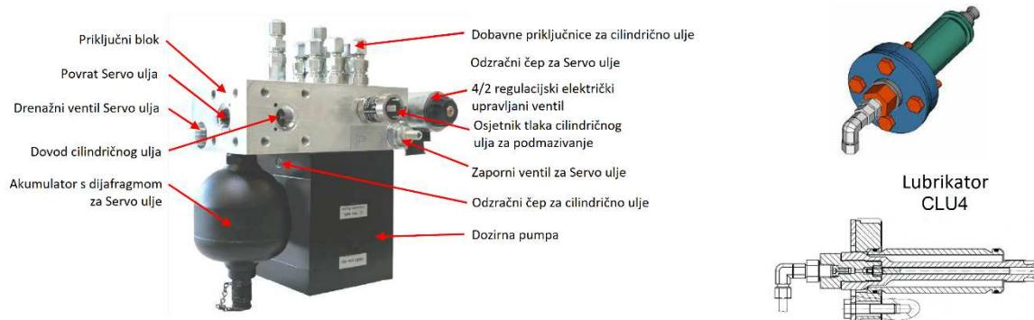
Slika 16. Modul za podmazivanje cilindra i lubrikator <sup>[12]</sup>
