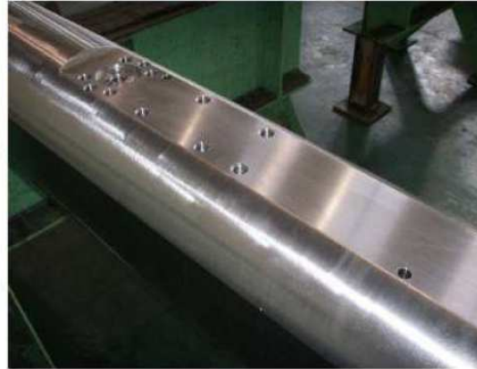
Slika 24. Zajednička Rail cijev goriva [2]
