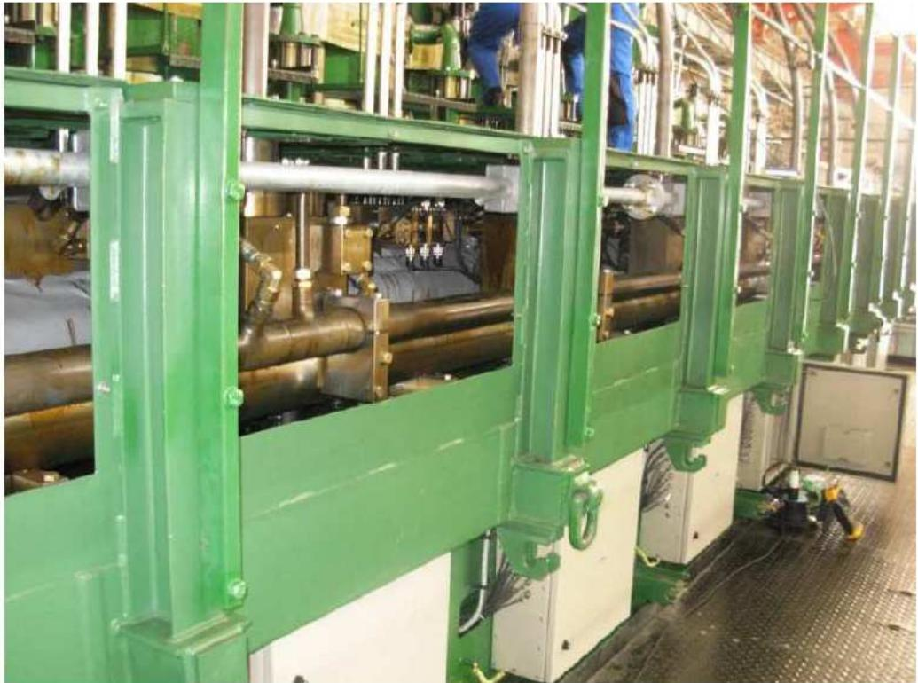
Slika 23. Rail jedinica na motoru [2]
