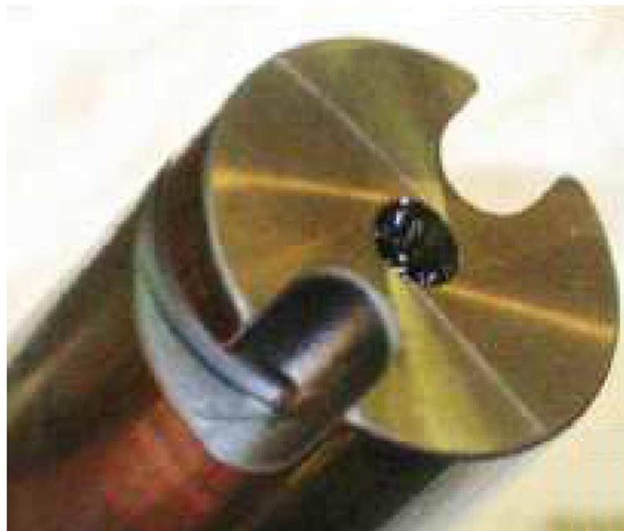
Slika 38. Vrh klipa pumpe goriva s regulacijskim utorima<sup>[2]</sup>
