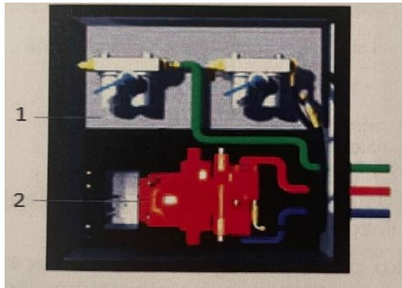
Slika 11-Prikaz elektrohidraulične jedinice
