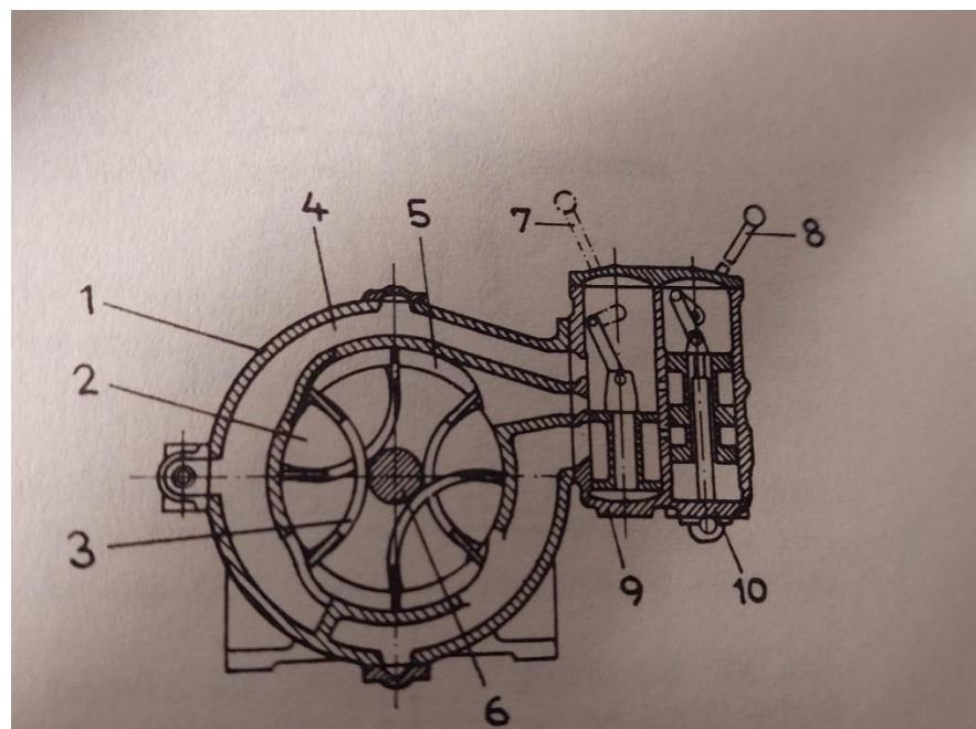
Slika 6-Prikaz niskotlačnog hidrauličnog motora s dva ventila upravljanja
