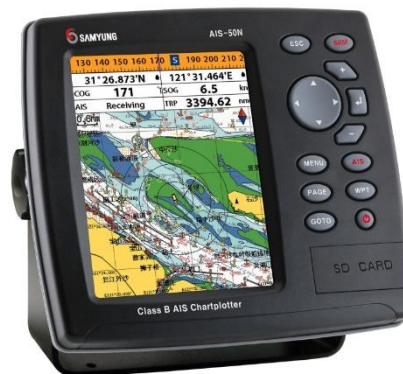
Slika 6. AIS uređaj klase B
