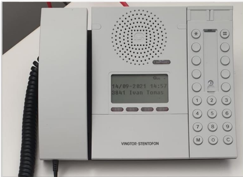
Slika 25. Telefon koji služi i kao PA objavljiivač
