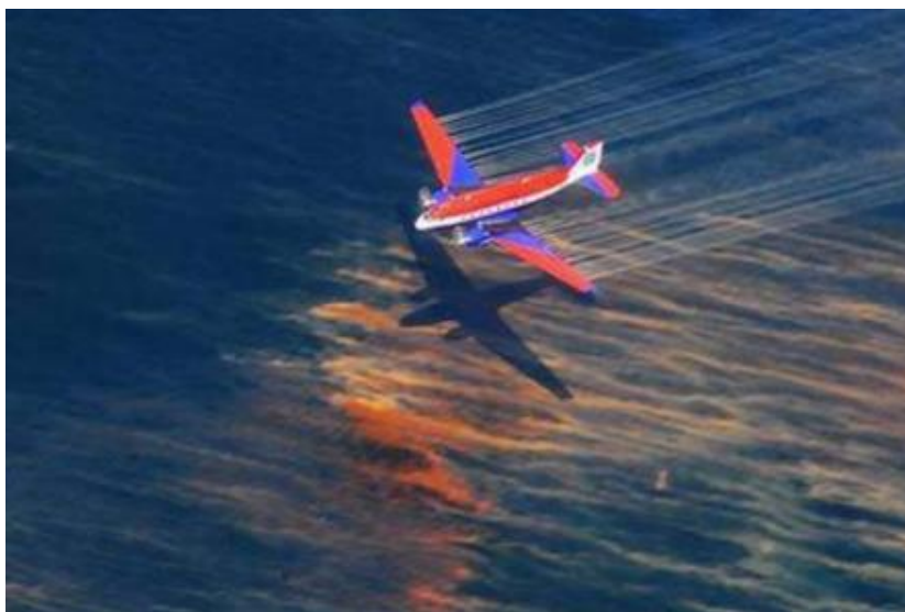
Slika 10. Djelovanje kemijskim raspršivačima na uljne mrlje iz zraka
