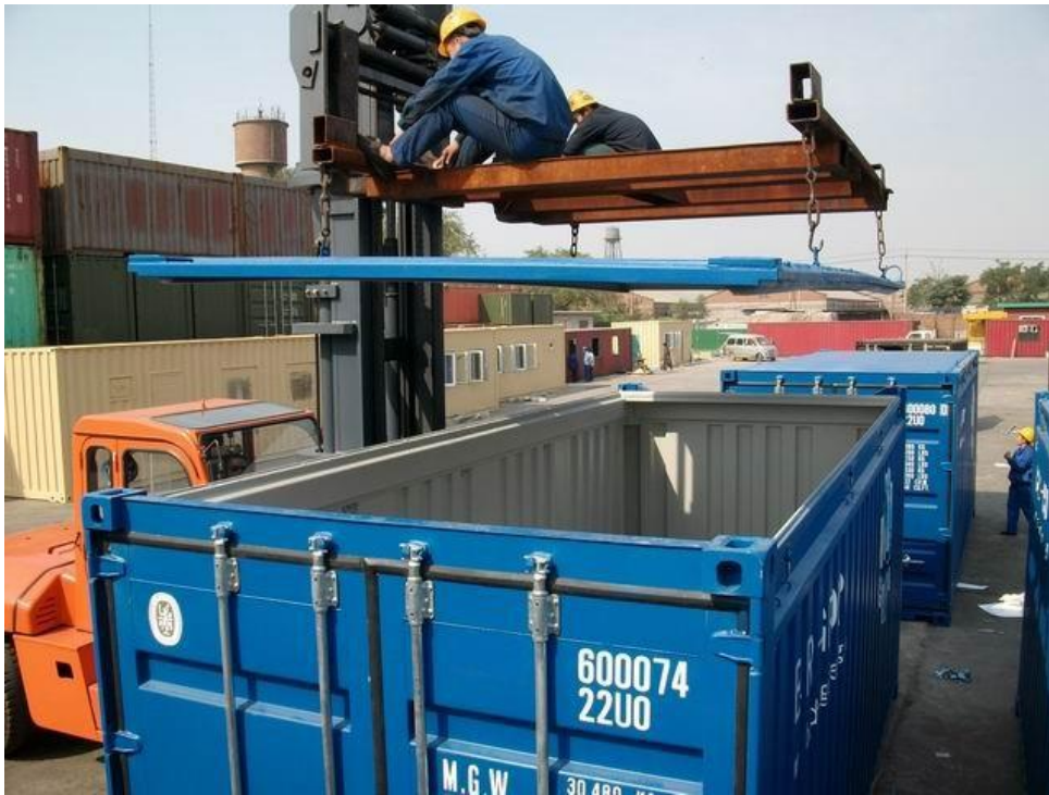
Slika 5. Prikaz kontejnera s pomičnim krovom
