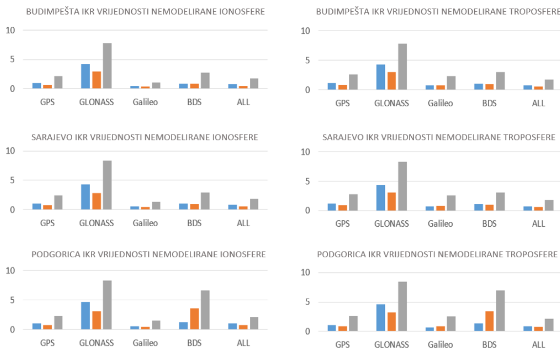
Slika 34. IKR vrijednosti scenarija nemodelirane ionosfere i nemodelirane troposfere promatranih stanica
