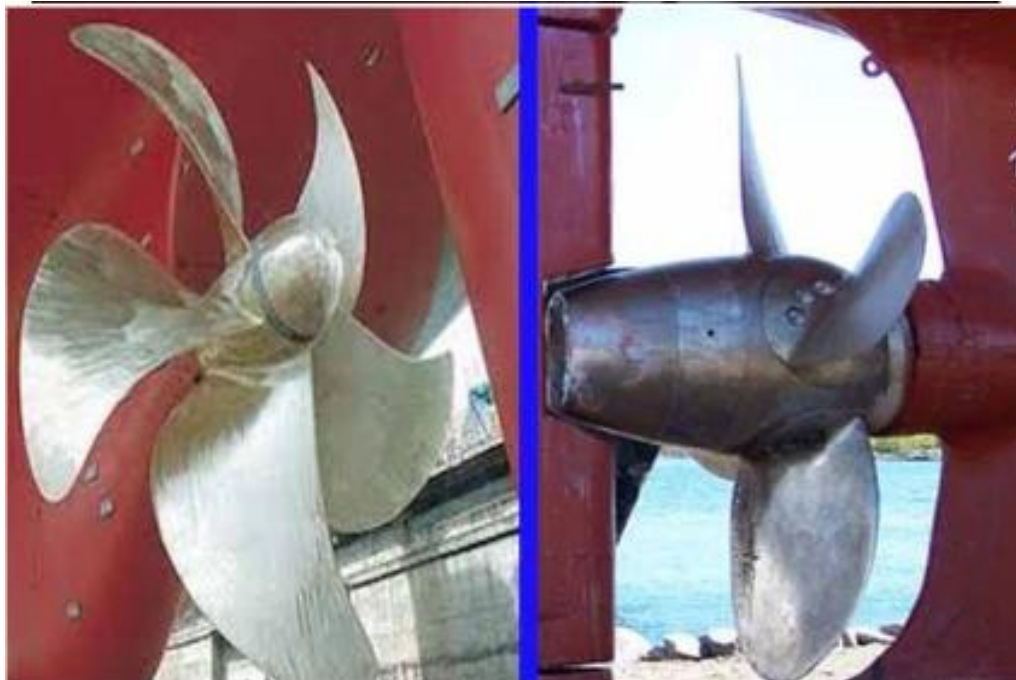
Sl. 7. Brodski vijak s promjenjivim korakom [12]
