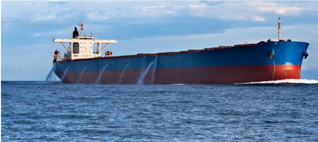
Slika 14. Izmjena balastne vode na otvorenom moru, [8]
