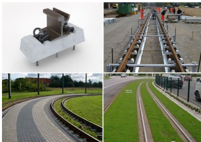
Slika 2. Detalji konstrukcije i izgled sistema „INPLACE“ ( https://het-group.com/de/produkte/travetto/inplace-b/inplace-b/produkt.html , 20.08.2021.)
