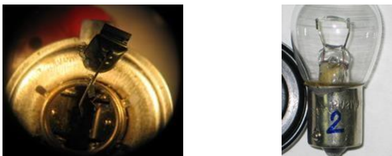
Slika 1. Razbijeni stakleni balon i prekinuto spiralno vlakno (levo) i netaknuti stakleni balon i deformisano spiralno vlakno (desno)
