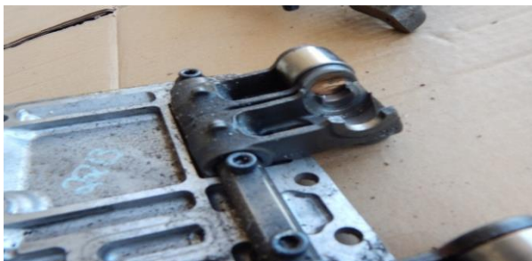
Slika 9. Pogled na oštećeno ležište rolnice koja usmerava kretanje šipke podizača šestog izduvnog ventila pogonskog motora
