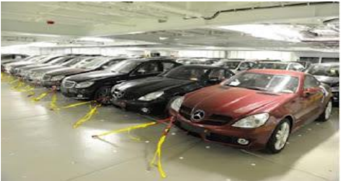
Slika 6. izvršene sigurnosne mjere – vozila vezana i pričvršćena.
