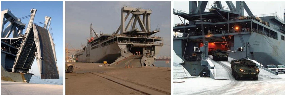
Slika 4. Krmena okretna rampa
