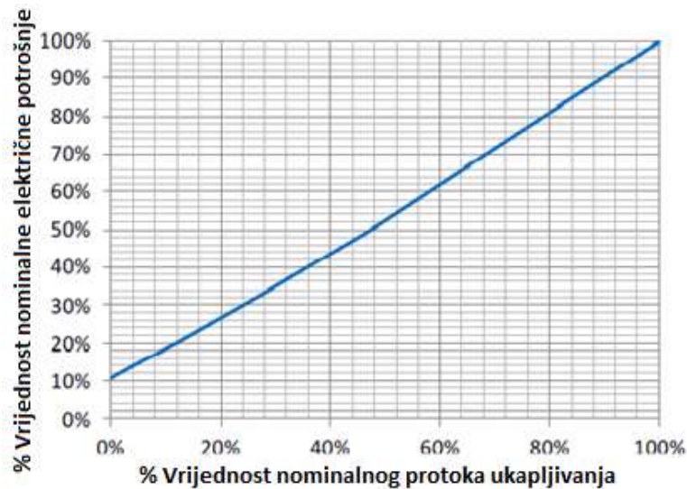
Slika 26: Očekivana električna potrošnja u odnosu na količinu protoka ukapljivanja [3]
