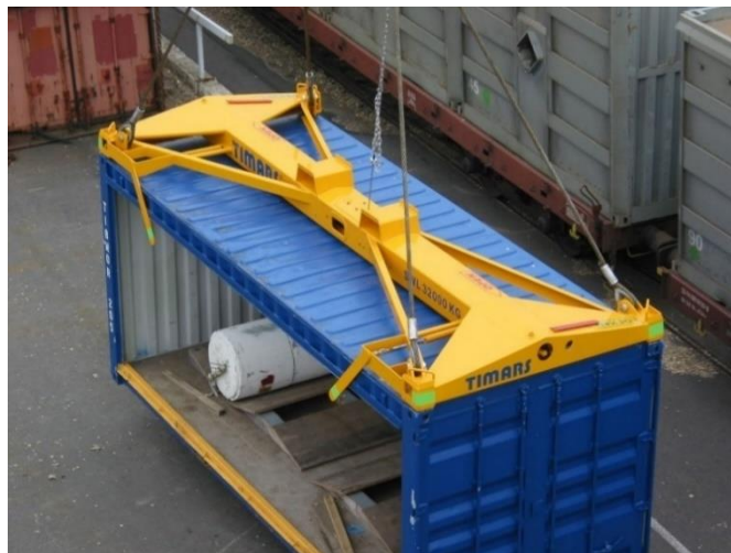
Slika 2. Hvatač kontejnera (engl. Spreader)
