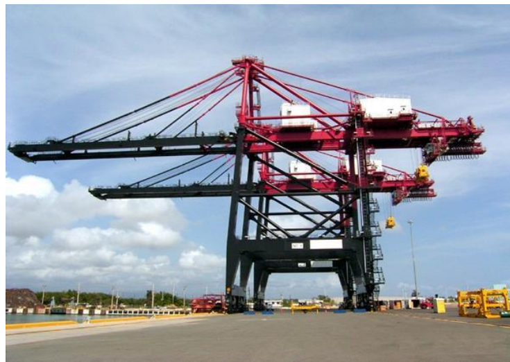
Slika 1. Kontejnerske obalne dizalice
