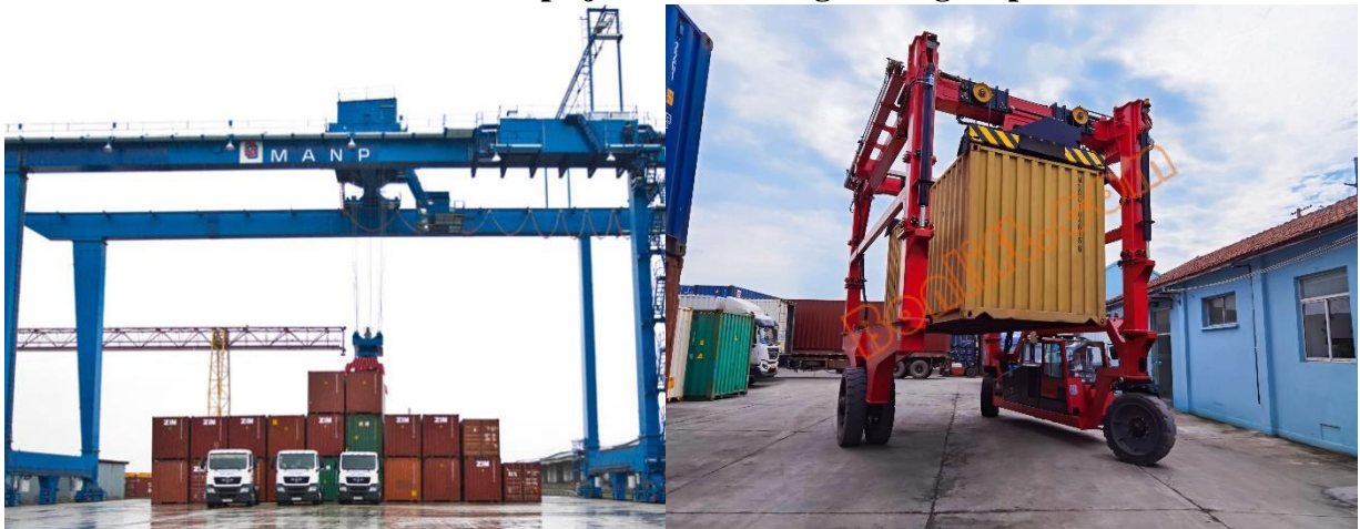
Slika 3. Portalni prijenosnik velikog i malog raspona
