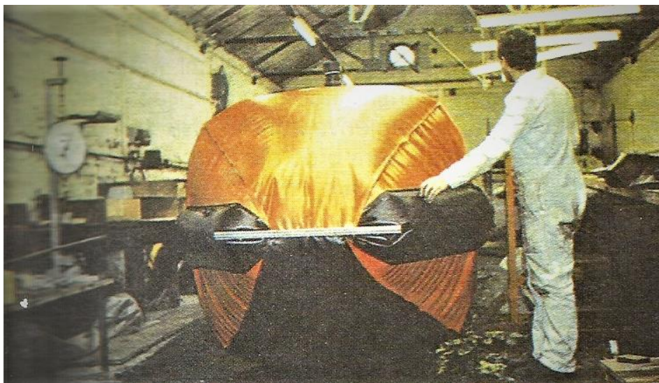
Slika 11. Plutajući poliuretanski spremnik za sakupljanje uljnog izljeva, [6]
