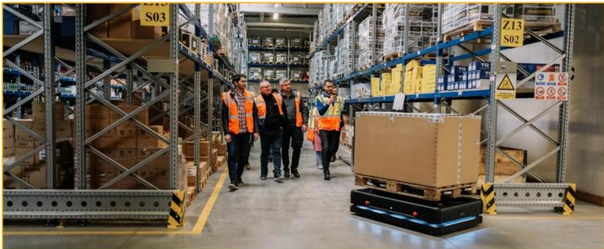
Slika 34. „Gideon“ autonomni robot u procesu transporta
