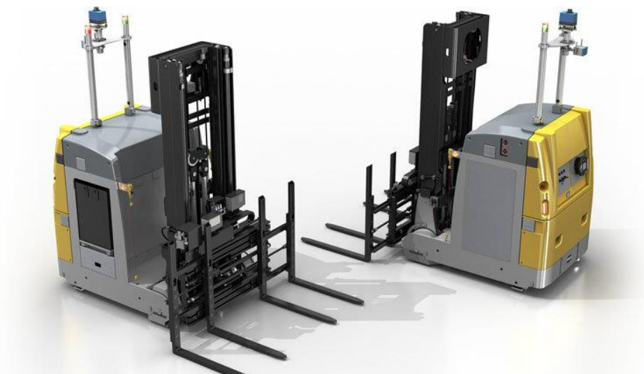
Slika 26. Prikaz automatiziranog AGV viličara
