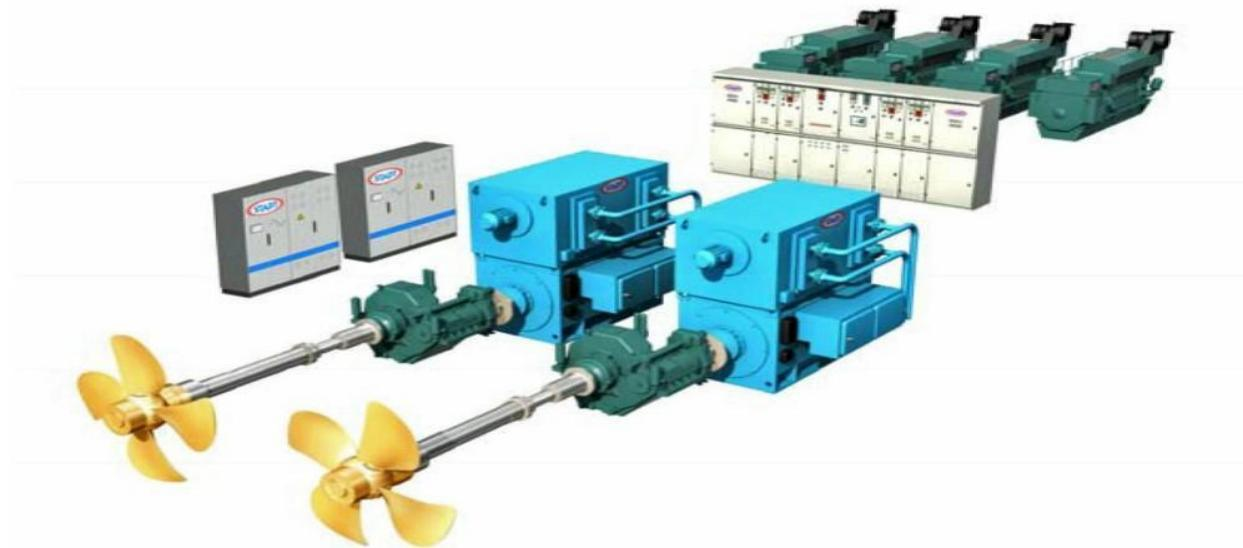
Slika 11 Prikaz dizel- električne propulzije
