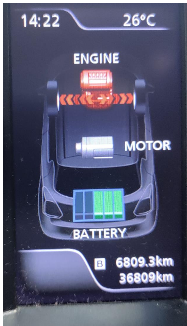
Slika 26. Grafički prikaz vožnje na pogon motora s unutarnjim izgaranjem
