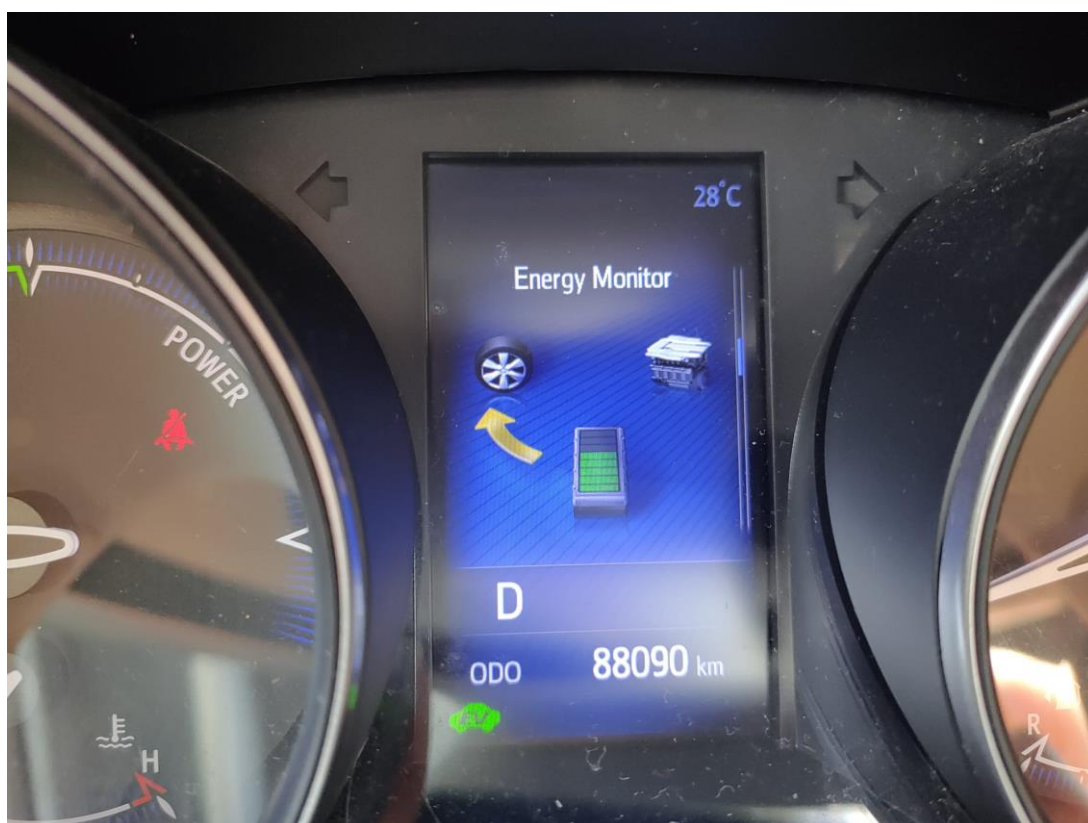
Slika 11. Prikaz prijenosa energije unutar hibridnog električnog vozila
