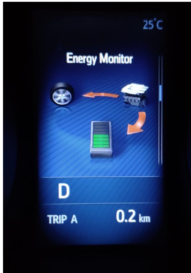
Slika 20. Grafički prikazan prijenos energije iz pogonskog motora
