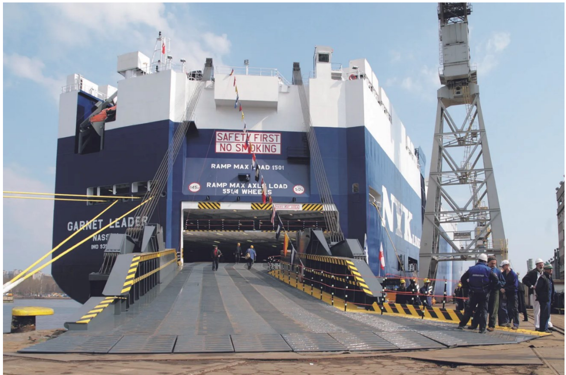
Slika 2. Primjer rampe na krmi broda
