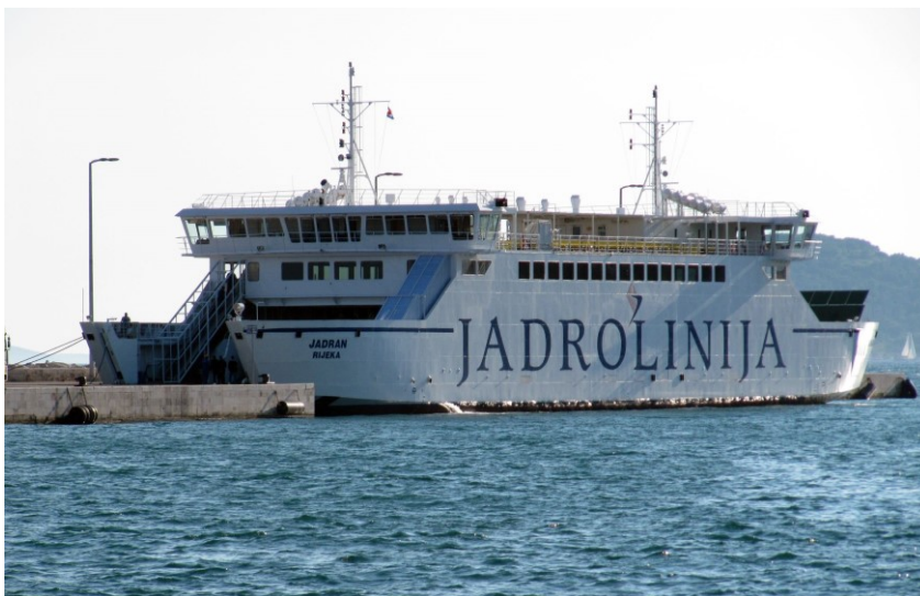
Slika 1 RO - RO putnički brod za srednje udaljenosti
