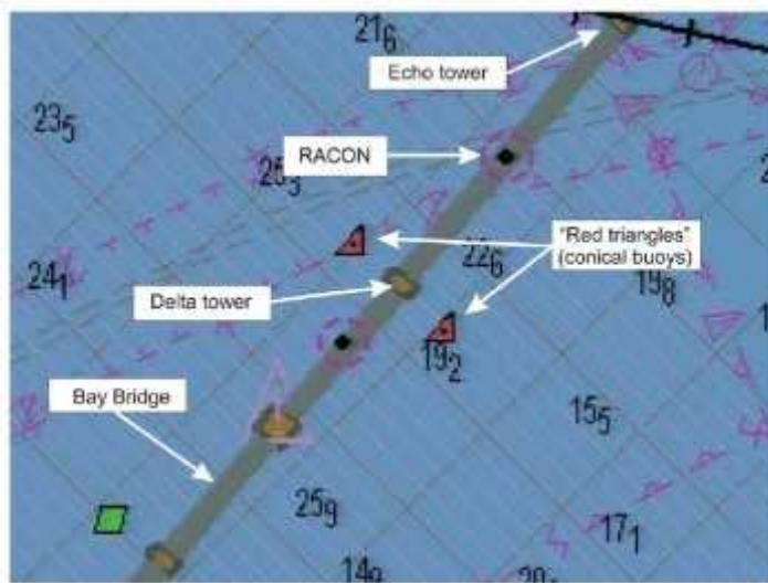
Slika 14. Uvećani dio elektroničke karte na brodu Cosco Busan. Dvije stožaste plutače, smještene s obje strane Delta tornja, prikazane su kao crveni trokuti na elektroničkoj karti. [15]
