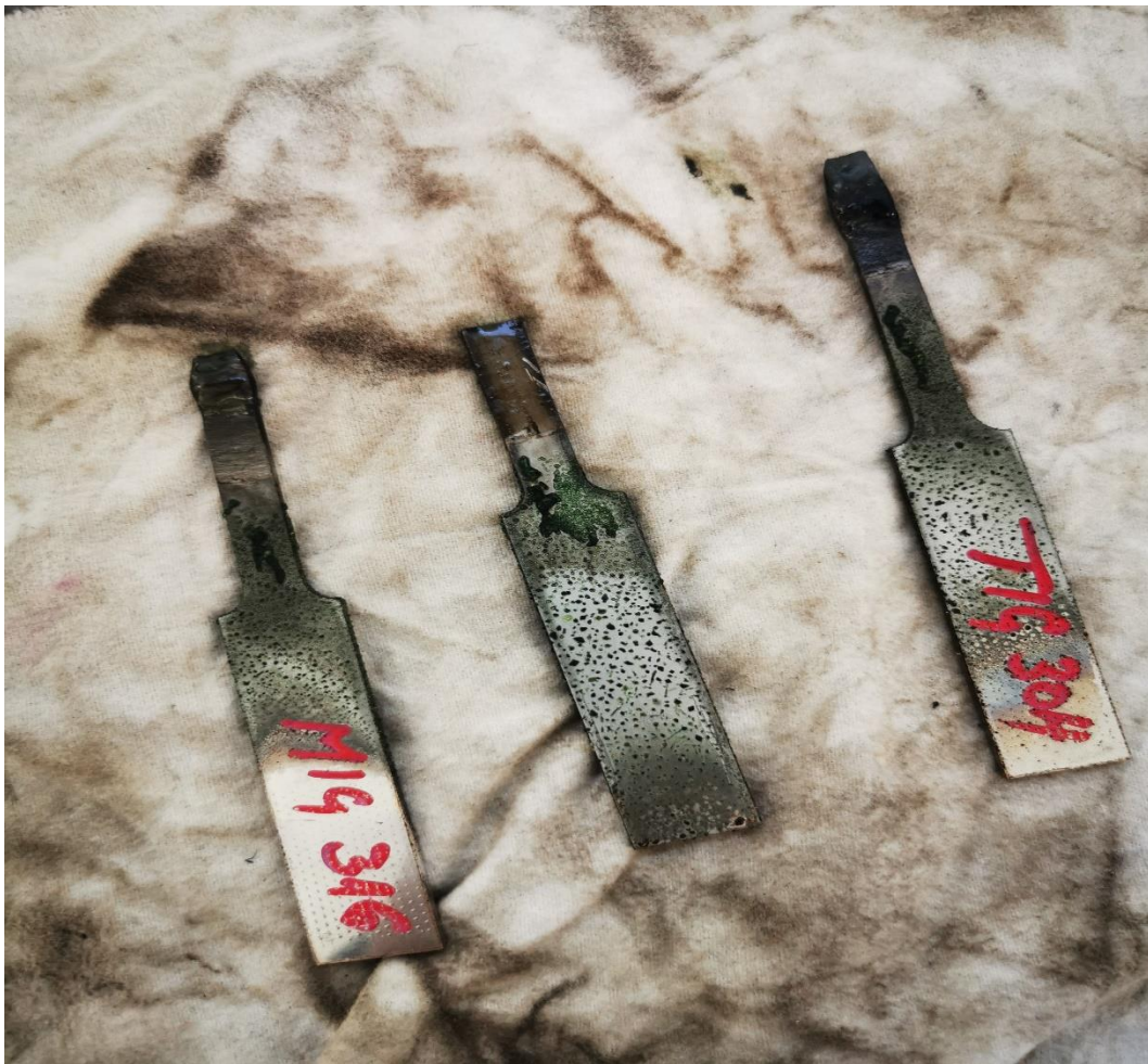
Slika 19. Izgled uzoraka neposredno nakon vađenja iz kiseline
