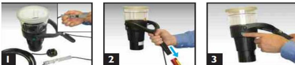
*Slika 29 Testiranje detektora plamena*
