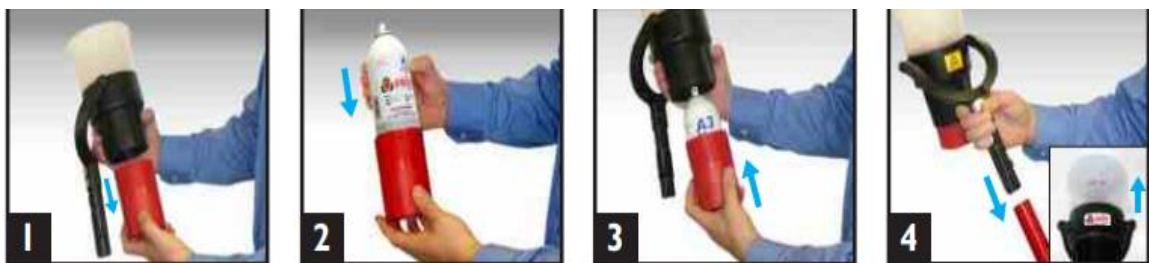
Slika 28 Testiranje detektora dima
