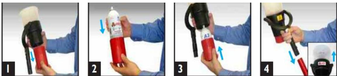
Slika 28 Testiranje detektora dima
