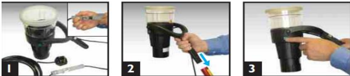
Slika 29 Testiranje detektora plamena
