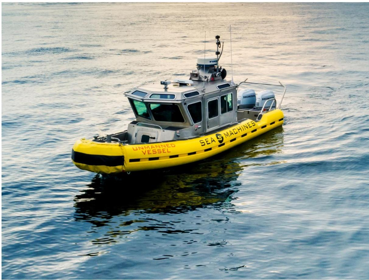
**Slika 25. Sea Machines Robotics autonomno pilotsko plovilo**
