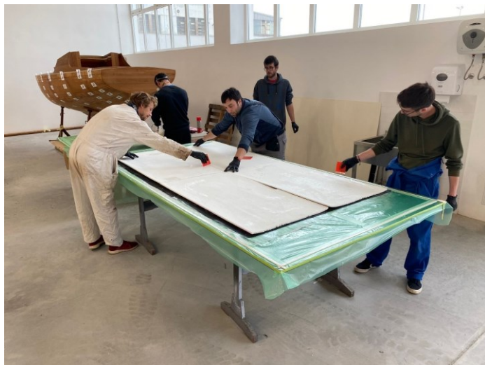
Slika 9 Prikaz procesa vacuum bagging-a
