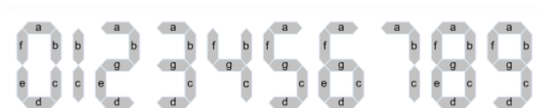
Slika 23: Dekadski brojevi u 7-segmentnom prikazu
