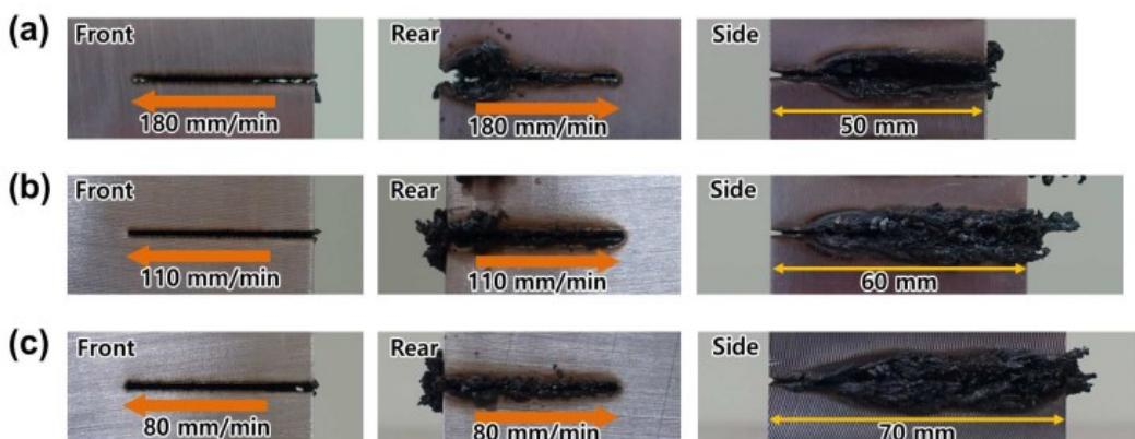
Slika 19. Prikaz rezova bez pomoćnog bušenja rupe
