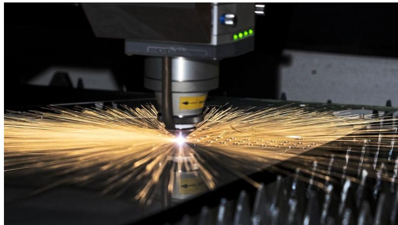
Slika 14. Prikaz stroja za rezanje pomoću laserskih vlakana
