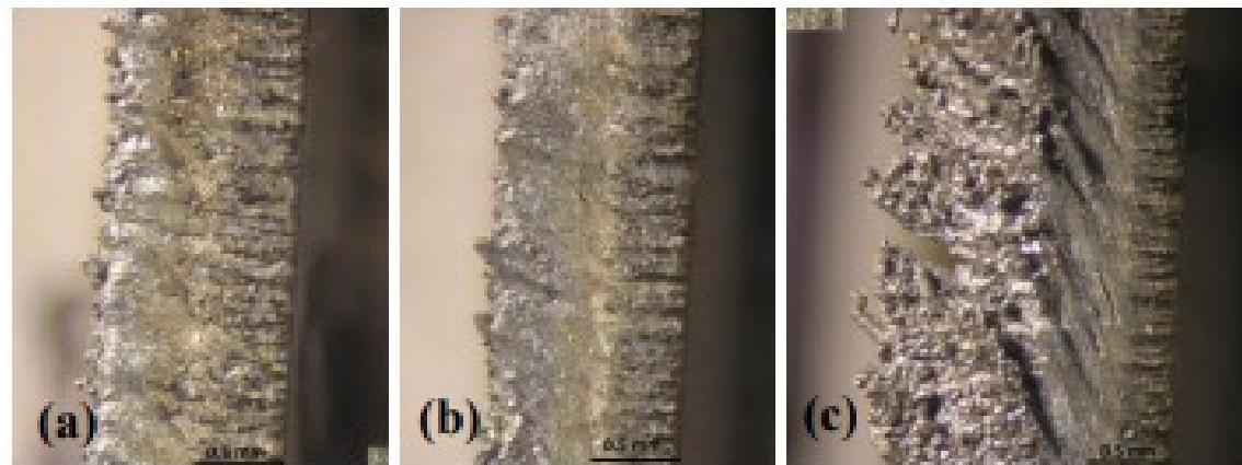
Slika 34. Makroografi porezanih površina sa snagom lasera 1500 W
