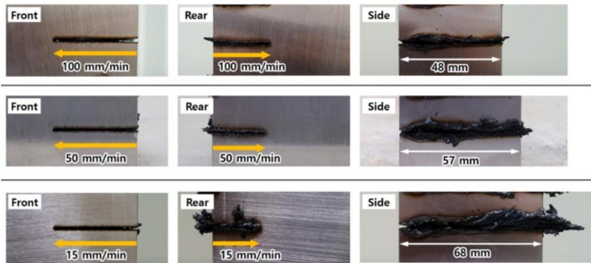
Slika 27. Prikaz uzoraka rezanih pod kutem od  $15^\circ$
