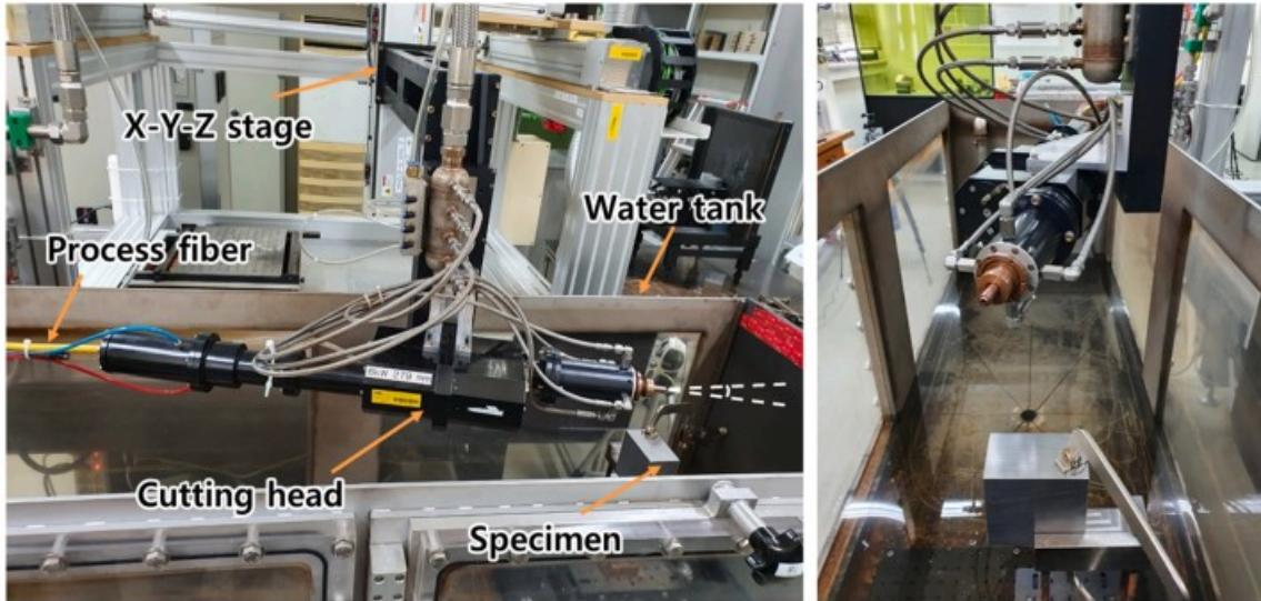
Slika 25. Prikaz podvodnog lasera za kutno rezanje
