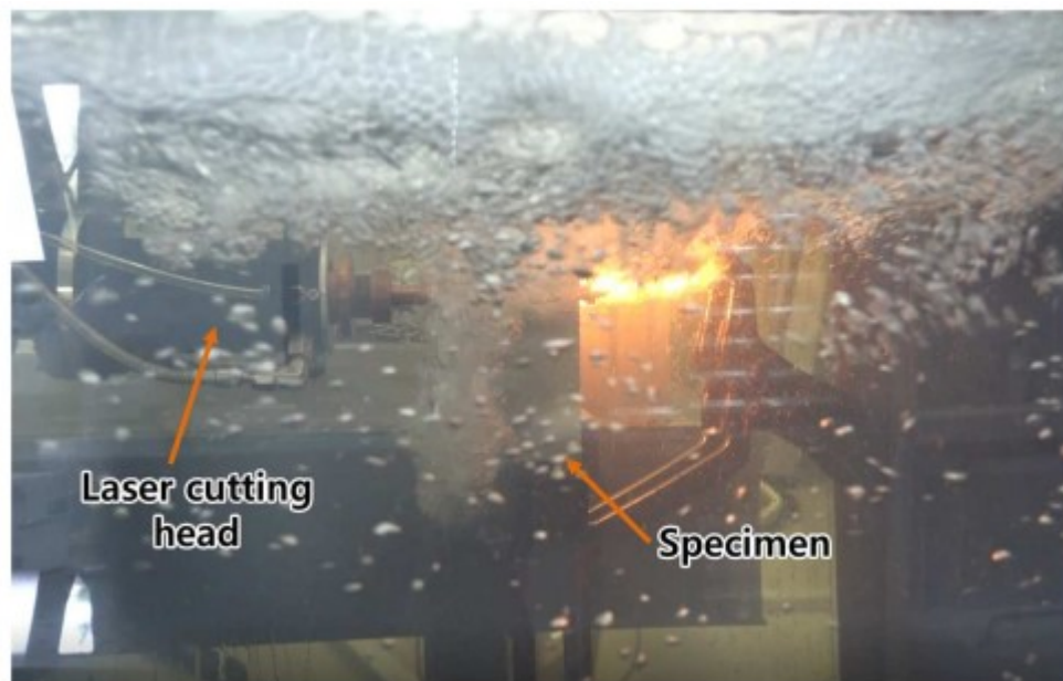
Slika 17. Prikaz procesa podvodnog rezanja laserom
