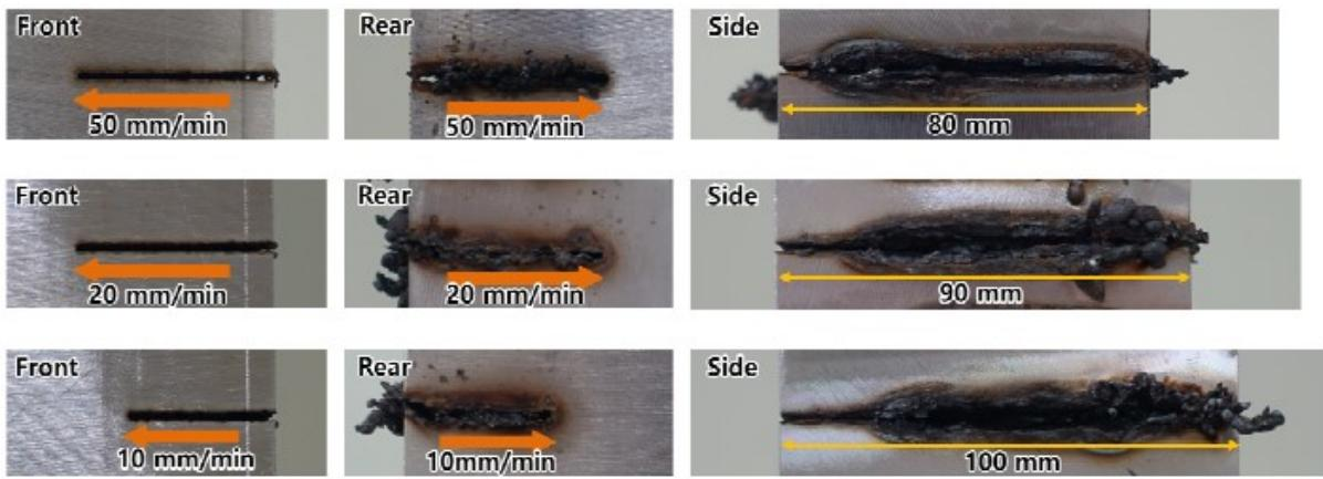
Slika 23. Prikaz uzoraka rezanih sa dvostrukom mlaznicom
