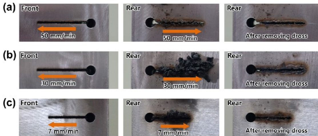
Slika 20. Prikaz uzoraka na kojima se primijenilo početno bušenje
