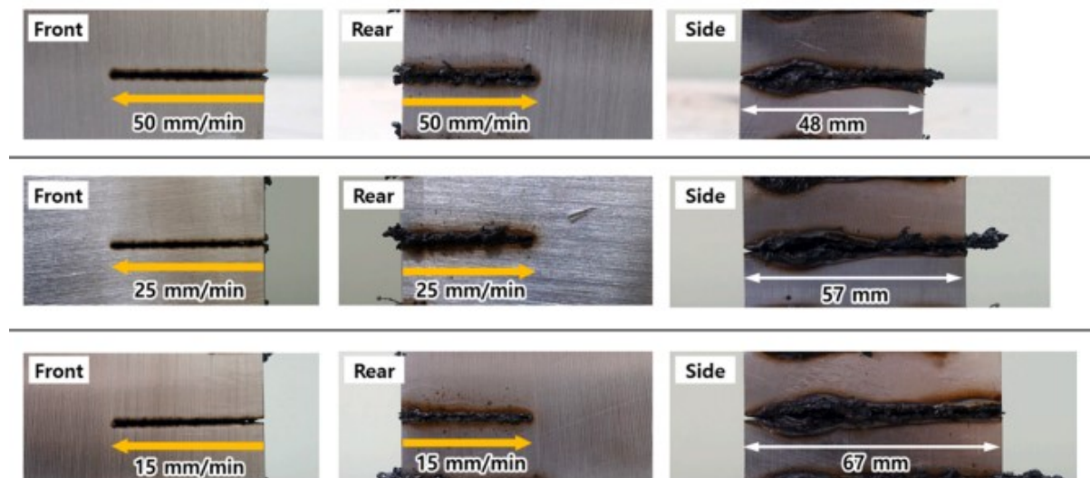
Slika 26. Prikaz uzoraka izrezanih pod kutem od 5°
