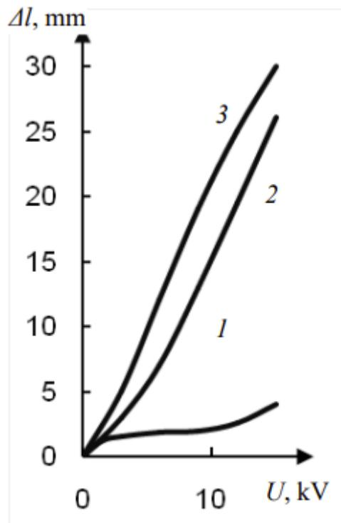
Slika 14-Ovisnost elektrode istezanje
