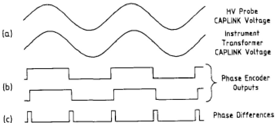
**Slika 19-Funkcionalni valni oblici sustava mjerena kuta dielektričnog gubitka**
