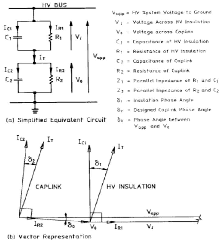
Slika 17-Pojednostavljeni ekvivalentni krug i vektorski dijagram za izolaciju
