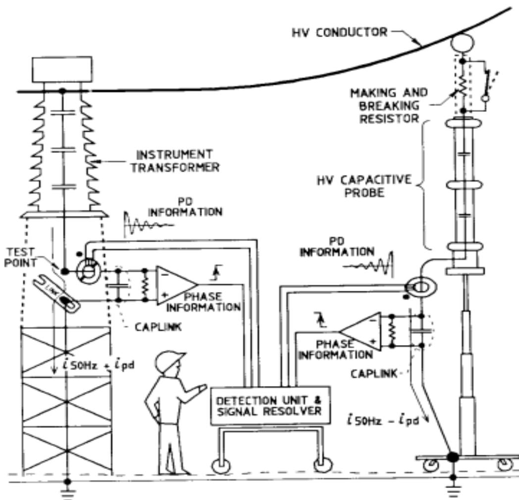
**Slika 18-Prikaz sustava za istovremeno mjerjenje djelomičnog pražnjenja i kuta dielektričnih gubitaka**
