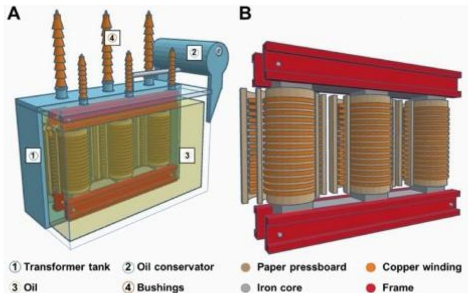
**Slika 6-Primjer izolacije transformatora**
