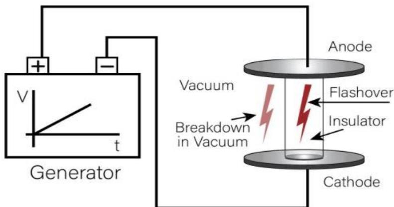
**Slika 3-Primjer vakuma kao električne izolacije**
