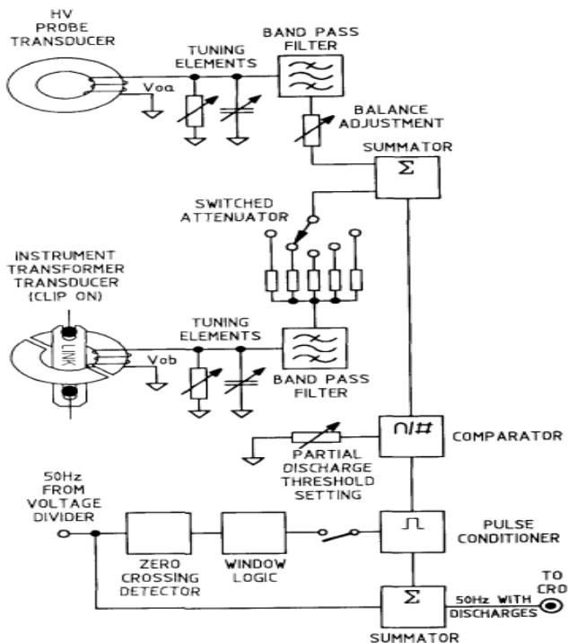
**Slika 16-Blok dijagram strujnog kruga za obradu signala za mjerjenje djelomičnog pražnjenja**
