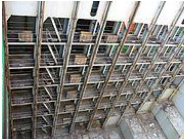
Slika 8. Ćelijska struktura teretnog prostora
