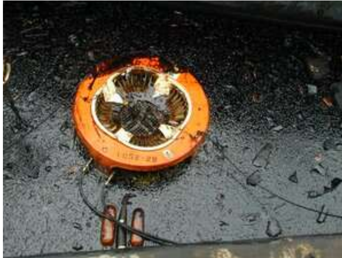
Slika 6 - Skimmer za uklanjanje nafte
