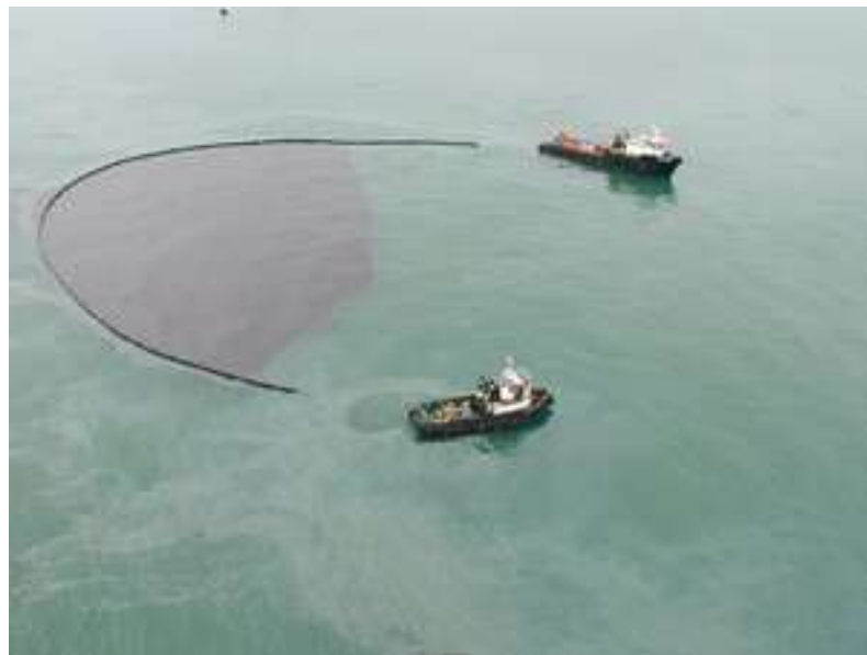
Slika 5 - Plutajuća brana u "U" obliku
