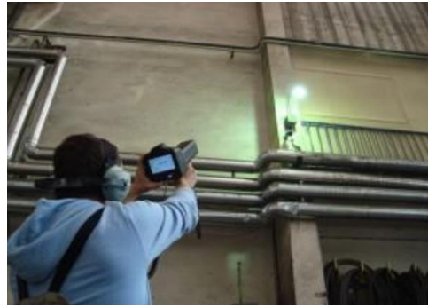
Slika 16. Beskontaktno otkrivanje kvarova
