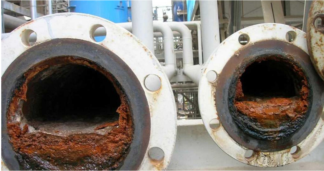
Slika 15: Ostaci u dobavnim cijevima morske vode bez korištenja MGPS sistema
