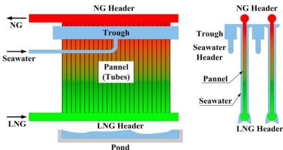
**Slika 12: Open rack vaporizer**
