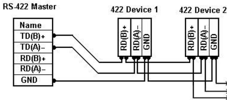
Slika 4. Grafički prikaz spajanja RS-422 u konfiguraciji dvožilnog spajanja
