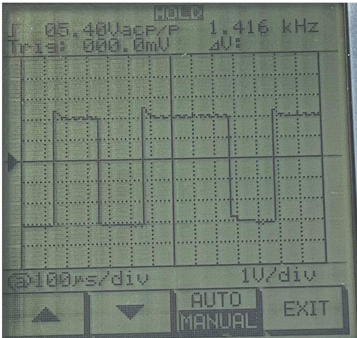
**Slika 41. Uzni parametri NMEA mreže bez spojenih prijemnih uređaja**
