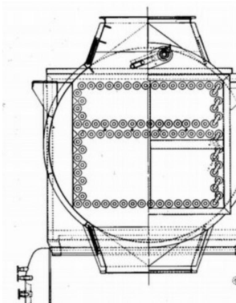
Slika 20: Samostalni utilizator s vlastitim parnim bubnjem [2]
