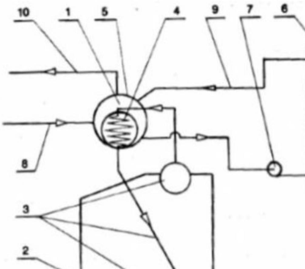
Slika 11: Prikaz povezivanja utilizatora sa sekundarnim sustavom dvotlačnog generatora pare [2]
