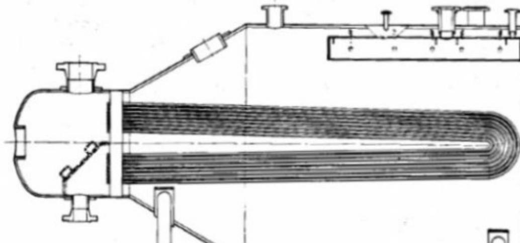
Slika 12: Parni bubanj sekundarnog sistema dvotlačnog generatora pare [2]
