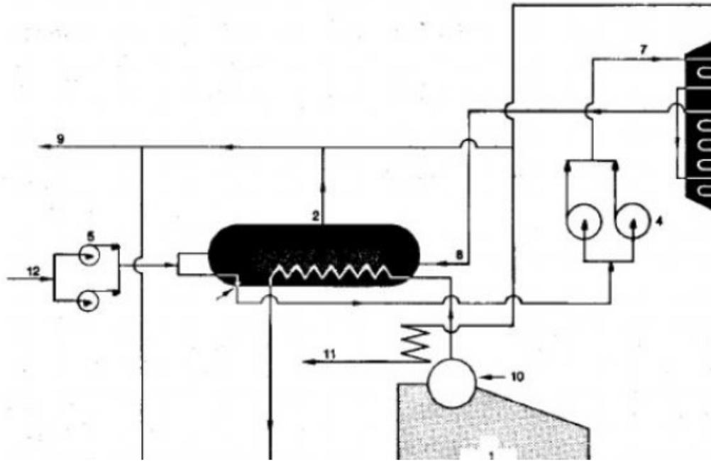
Slika13: Shema spoja utilizatora i loženog dvotlačnog generatora [2]
