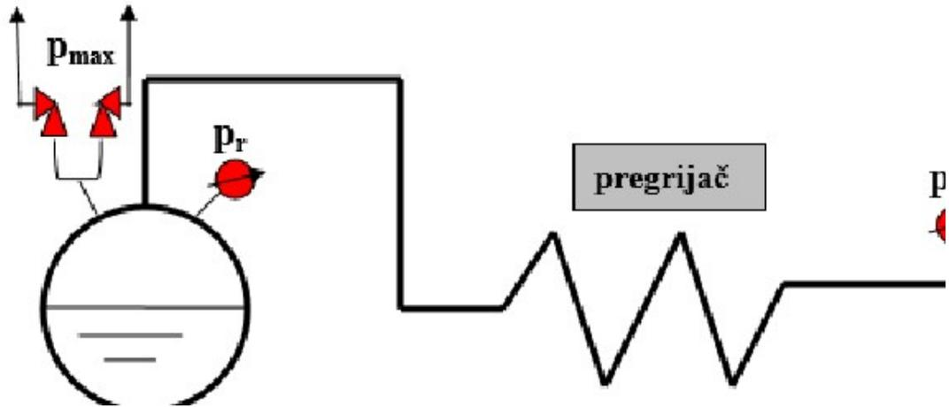
Slika 10: Prikaz Maksimalnog, radnog i izlaznog tlaka [8]
