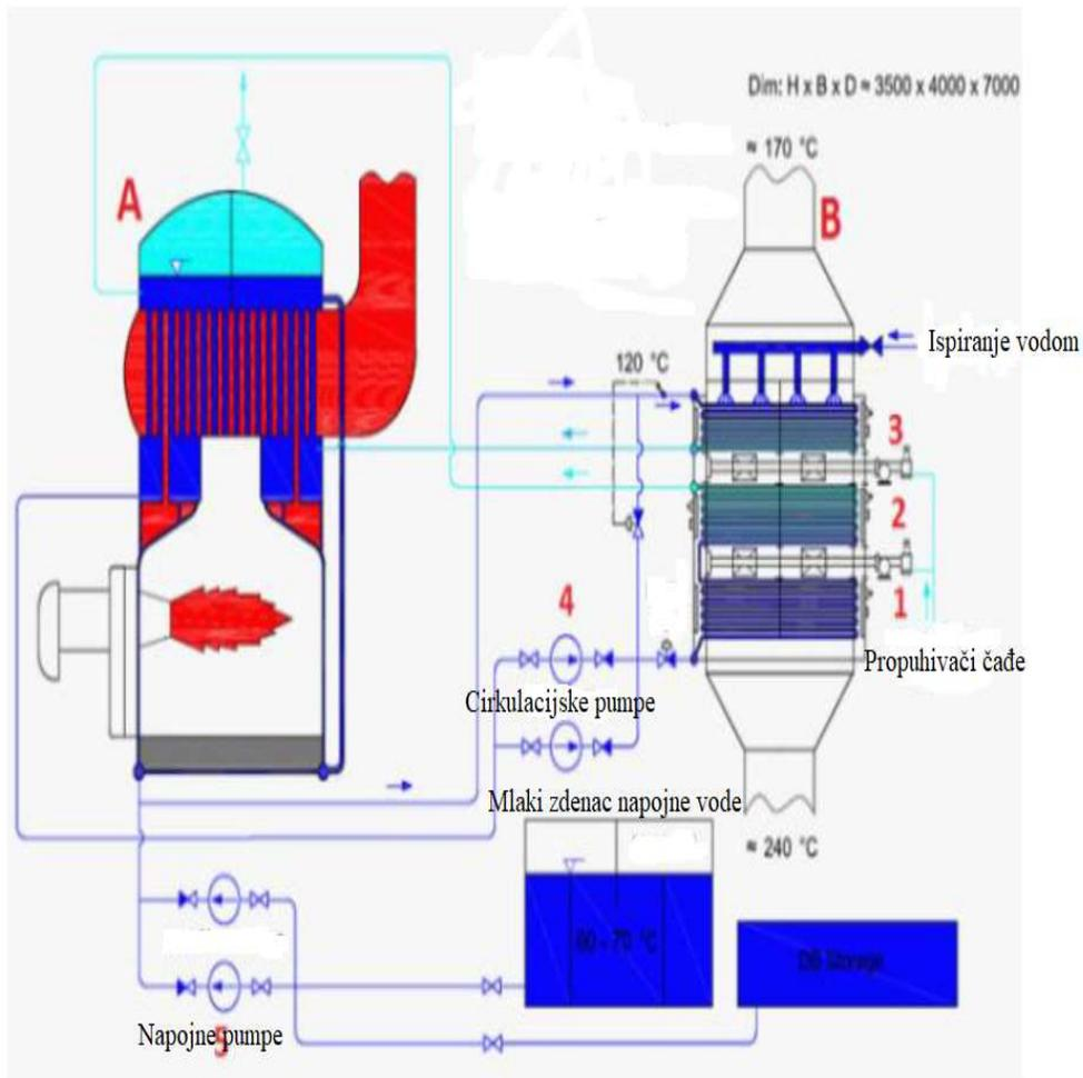
Slika15: Spoj loženog generatora pare i utilizatora [11]
