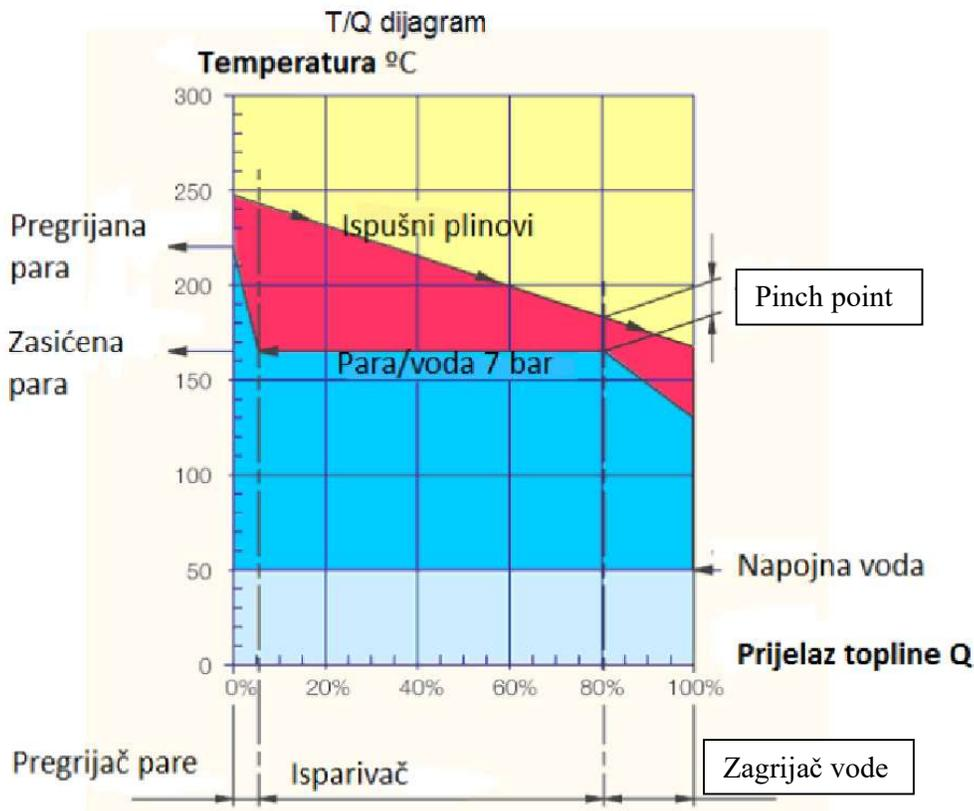
Slika24: T/Q dijagram generatora pare na ispušne plinove [15]
