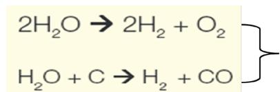
Prilikom nastanka požara i temperature požara veće od 1100°C dolazi do pregaranja cijevi generatora pare na ispušne plinove i izgaranja metala (čelika) [15]:
